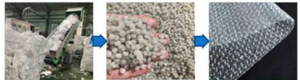
使用後のストレッチフィルムを加工したペレットを原料としてプチプチを製造
